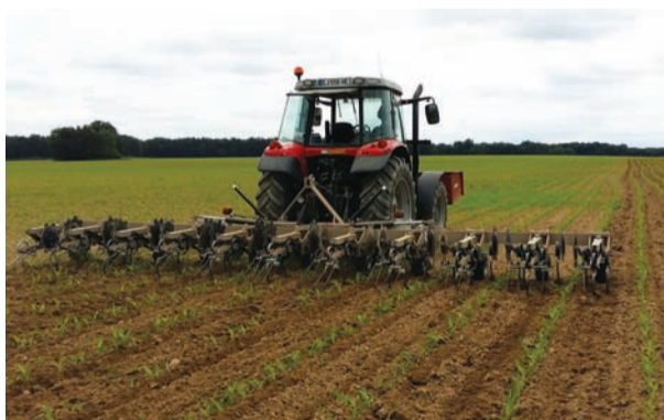
La bineuse à dents Binov s'adapte à différentes natures de sols avec un travail du sol bien plus homogène.
